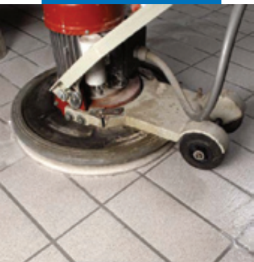
Очистка поверхности водой и дисковой машиной с абразивным падом, таким как "Scotch-Brite®"
